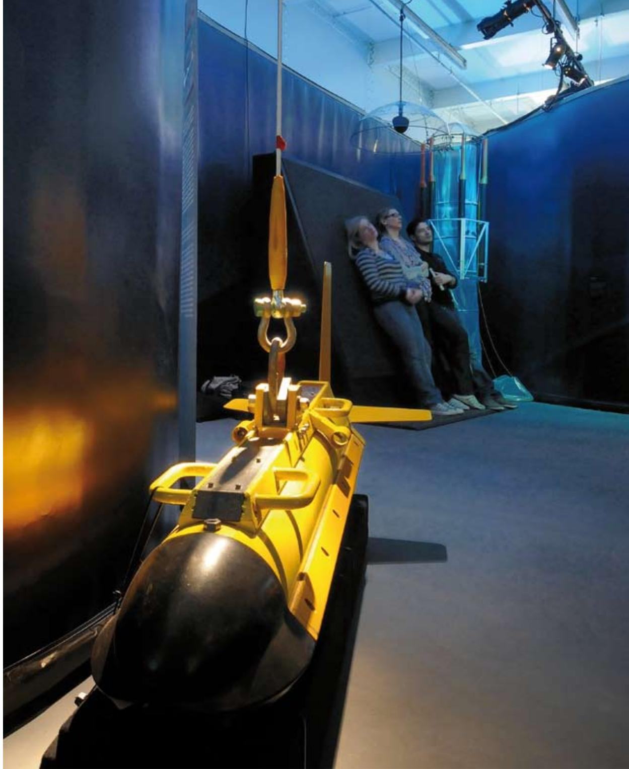
28 Seitensichtsonar: scannt den Meeresboden Sidescan sonar: scans the sea floor
