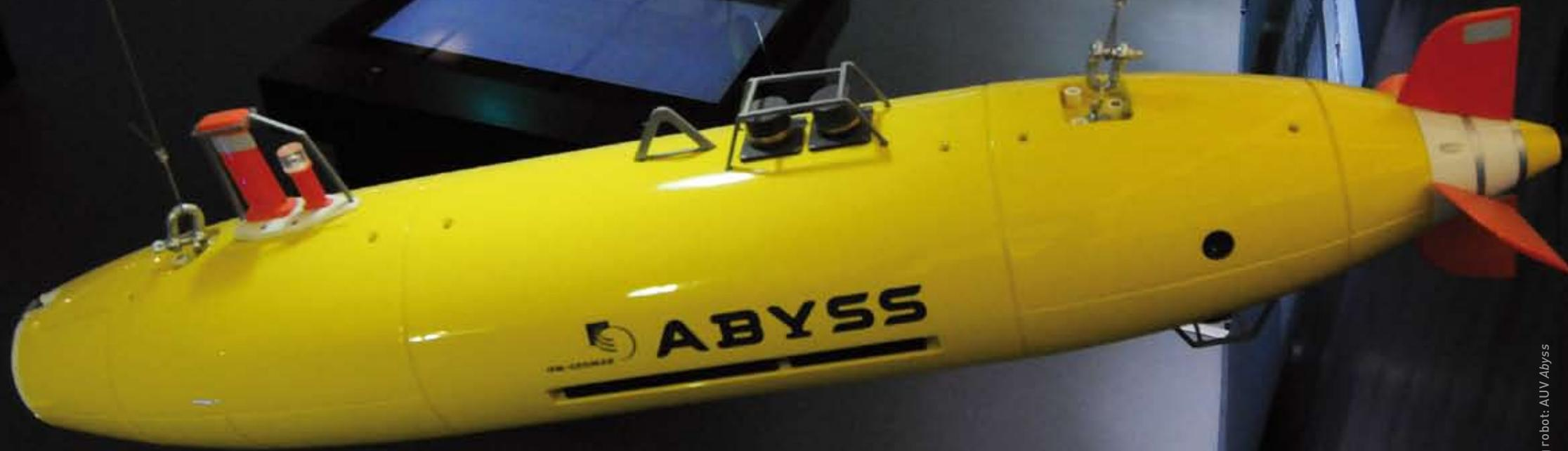
26 Das autonome Unterwasservehikel (AUV) „Abyss“ taucht bis zu 6.000 Meter tief. Mit Hilfe von Echoloten und Sensoren kann es den Meeresboden kartieren oder physikalische Daten aus der Wassersäule sammeln.
