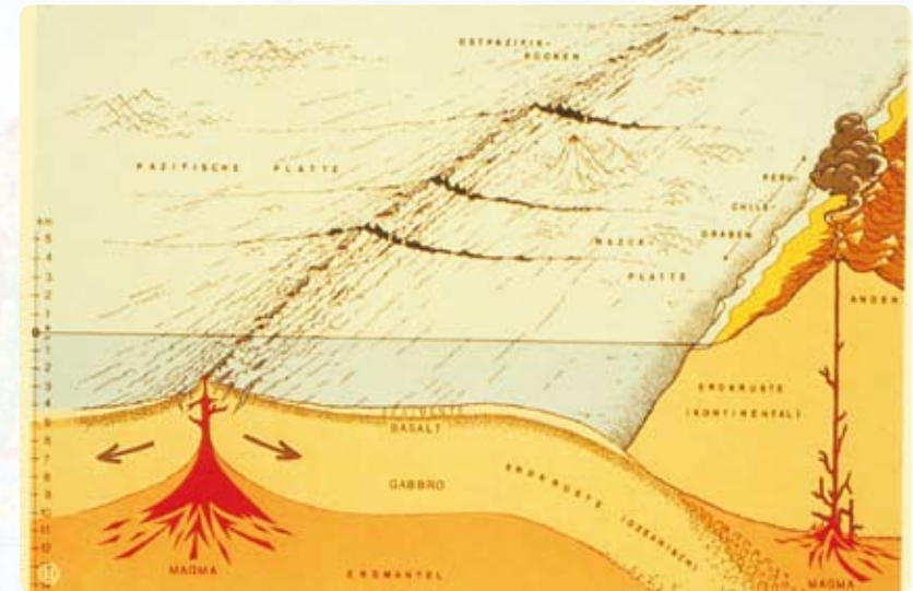
Abb.3: Schema der Bildung und Wiederaufschmelzung von ozeanischer Kruste. Die im Zentrum von langgestreckten submarinen Gebirgszügen durch das Aufdringen und Erstarren magmatischer Schmelzen neu entstehende ozeanische Kruste wird mit Geschwindigkeiten von bis zu 10 cm/Jahr vom Ort der Entstehung wegtransportiert. In so genannten Subduktionszonen wird die dann schon einige Millionen Jahre alte, kalte und damit schwere Kruste unter den Rand der Kontinente geschoben und hier aufgeschmolzen. Dieser Prozess ist zum Beispiel die Ursache für den Vulkanismus in den Anden.
