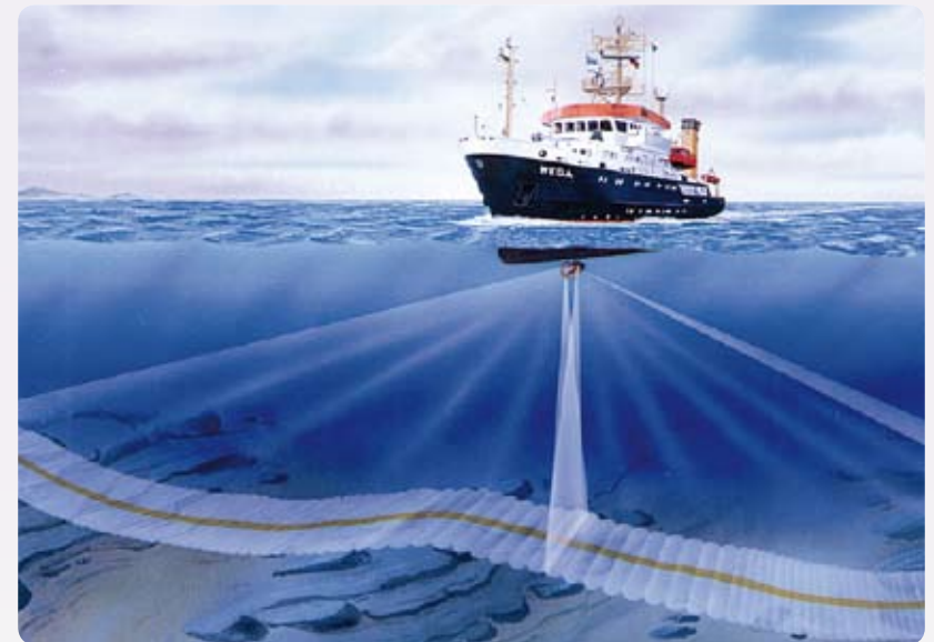
Abb. 2: Prinzipskizze eines schiffsgestützten Fächerecholotes. Der Schallimpuls wird unter dem Schiff erzeugt und als Fächer abgestrahlt. Aus der Rücklaufzeit der Signale kann ein Geländemodell errechnet werden. Quelle: Atlas Hydrographic.
