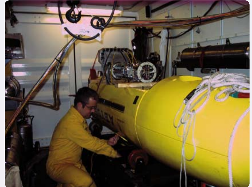
Abb. 9: Marcel Rothenbek bei Wartungsarbeiten am Gerät. Die Elektronik im AUV ist durch dicke Titanflaschen vor dem Umgebungsdruck geschützt. Im Zentrum des Bildes sieht man eine dieser Flaschen, die aus dem „Bauch“ des AUV entnommen wurde, im geöffneten Zustand.
