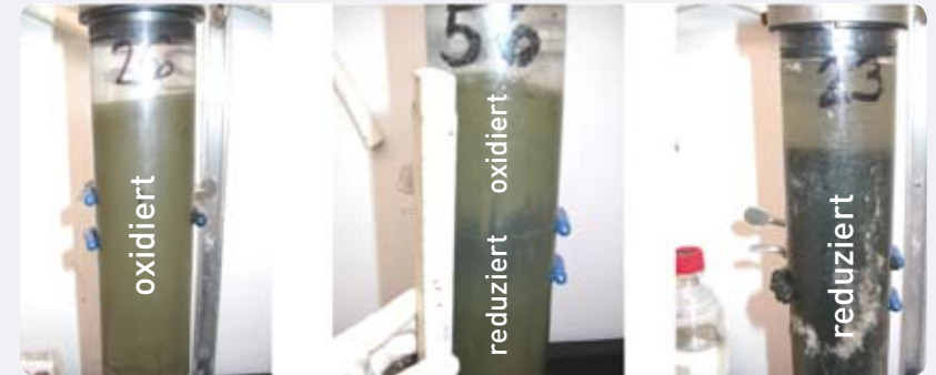
Abb. 8: Schon an der Farbe des Sedimentes kann man auf die mikrobiellen Prozesse schließen. Im schwarzen Sediment findet Sulfatatmung statt. Der freigesetzte Schwefelwasserstoff reagiert mit Eisen und bildet schwarzes Eisensulfid. Man spricht hier von reduzierendem Sediment. Im Gegensatz dazu sind in den grünen Teilen des Sedimentes alle Bestandteile oxidiert.
