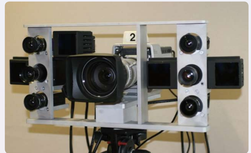
Abb. 10: Aufnahmesystem für Autostereoskopie-Fernsehen. In der Mitte die Farbkamera, rechts und links Tiefenkameras, um die Umgebungsentfernung zu berechnen. Das System erzeugt das Spezialformat (Farbe+Tiefe) für das brillenlose 3D-Sehen im Fernsehen. Foto: © CAU
