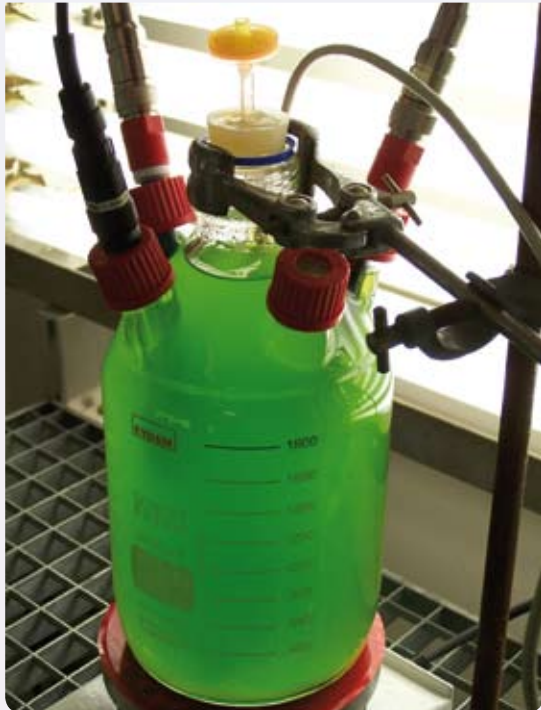
Abb. 7: Forschungs-Photobioreaktor zur Untersuchung der Biowasserstoffproduktion durch Mikroalgen im Labormaßstab.
