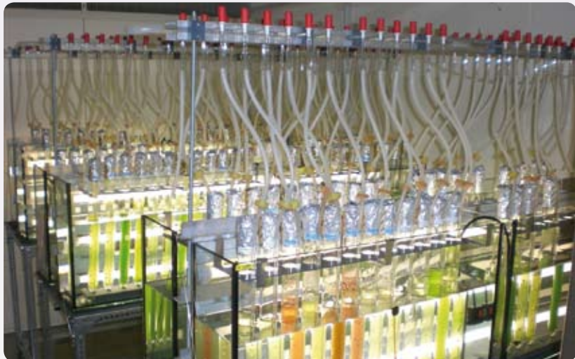
Abb. 4 und 5: Anzucht mit Mikroalgen im Labor in Röhren, die mit Luft durchblubbert werden.
