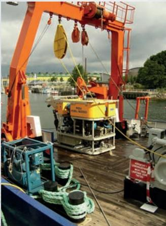
**Das ROV KIEL 6000 ist ein für wissenschaftliche Einsätze in der Tiefsee konzipiertes und über ein Tiefsee-Glasfaserkabel ferngesteuertes System.**
